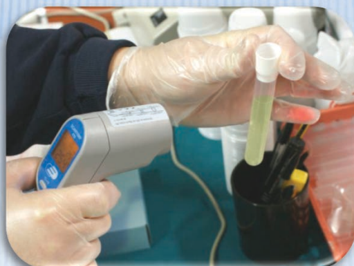
5. Misurazione della temperatura per verificare eventuali alterazioni del campione
